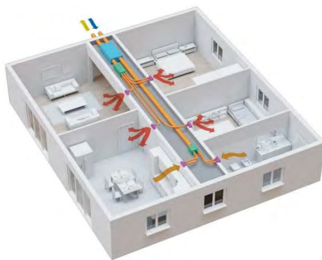
ESEMPIO DI INSTALLAZIONE VENTILAZIONE MECCANICA CONTROLLATA (VMC)
